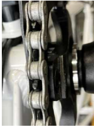
チェーンをセットするときに チェーン外プレート間に厚歯 内プレート間に薄歯が乗るようにする。
